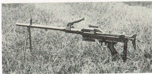
Fusil-mitrailleur vu de gauche avec bipied et béquille.
